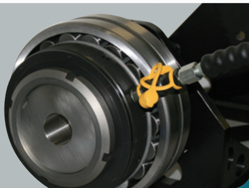
Ściąganie tulei wciąganej za pomocą nakrętki hydraulicznej
