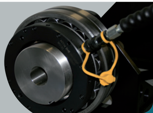
Ściąganie tulei wciskanej za pomocą nakrętki hydraulicznej
